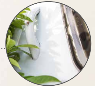
Bug, Dach und Heck aus widerstandsfähigem GFK
