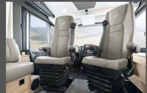
First class Reisen mit stoßabsorbierenden Luftschwingsitzen inkl. beheizter und belüfteter Sitzfläche (Option).
