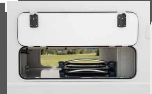
Frostgeschützt: beheizter Doppelboden mit viel Stauraum.
